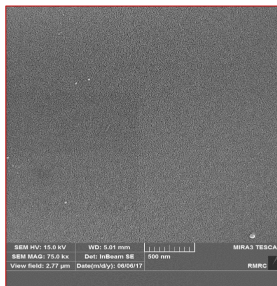
شکل ۲- تصویر SEM نانوذرات گاما آلومینا ساخته شده به روش سل-ژل
