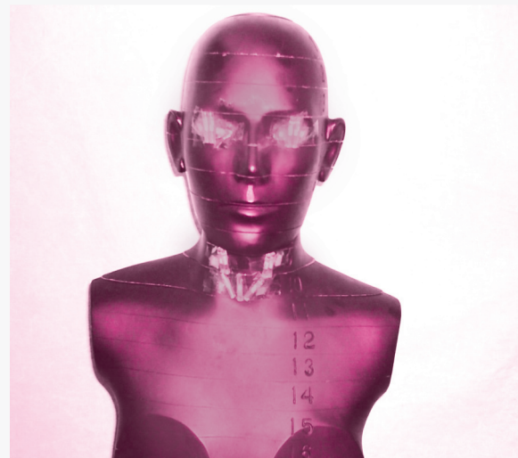
شکل ۲: فانتوم راندو دزیمترها روی ناحیه تیروئید و چشم‌ها قرار گرفته‌اند.
